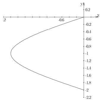
*Bild:* Natürlicher Spline zwischen den Punkten  $(0, 0)$ ,  $(-2, -1)$  und  $(0, -2)$
